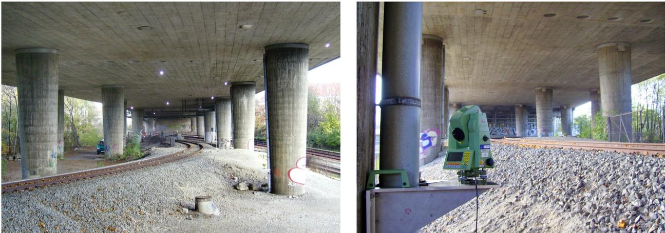
**Abbildung 6.4:** Deckenprismen an der Brückenunterseite (links) und berührungslose Messung der Objektpunkte von einem Konsolenstandpunkt aus (rechts)
