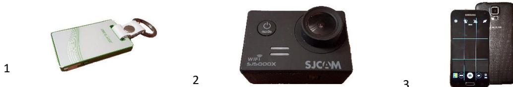
**Abb.:** Verwendete Sensoren zur Erfassung hochgenauer Spieler-Trajektorien: GPS-Logger, Action-Kameras bzw. Smartphones (v.l.n.r.).
