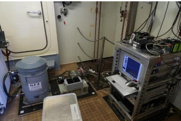
*Abb. Das für die Messung von den Kollegen des GFZ Potsdam eingesetzte Seegravimeter vom Typ „Chekan“ (links) ist ein empfindliches und komplexes Messinstrument und arbeitet unter Laborbedingungen. Die Daten werden mit spezialisierter Computertechnik (rechts) aufgezeichnet.*
