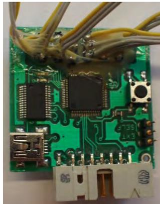
Abbildung 60: Kontroller zur Übertragung des Strobe-Signals von der Kamera zur MD4-1000 und zum synchronen Auslösen aller 5 Kameras
