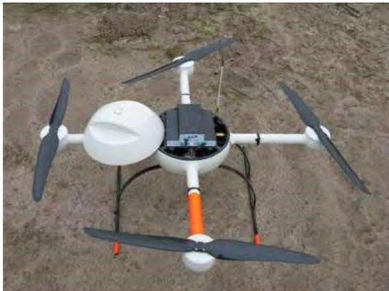
Abbildung 48: MD4-1000 mit offenem Gehäuse
