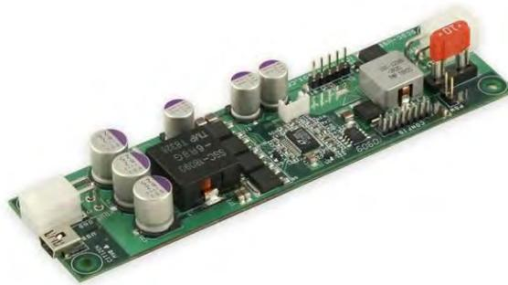
Abbildung 59: DC-DC Netzteil<sup>30</sup>
