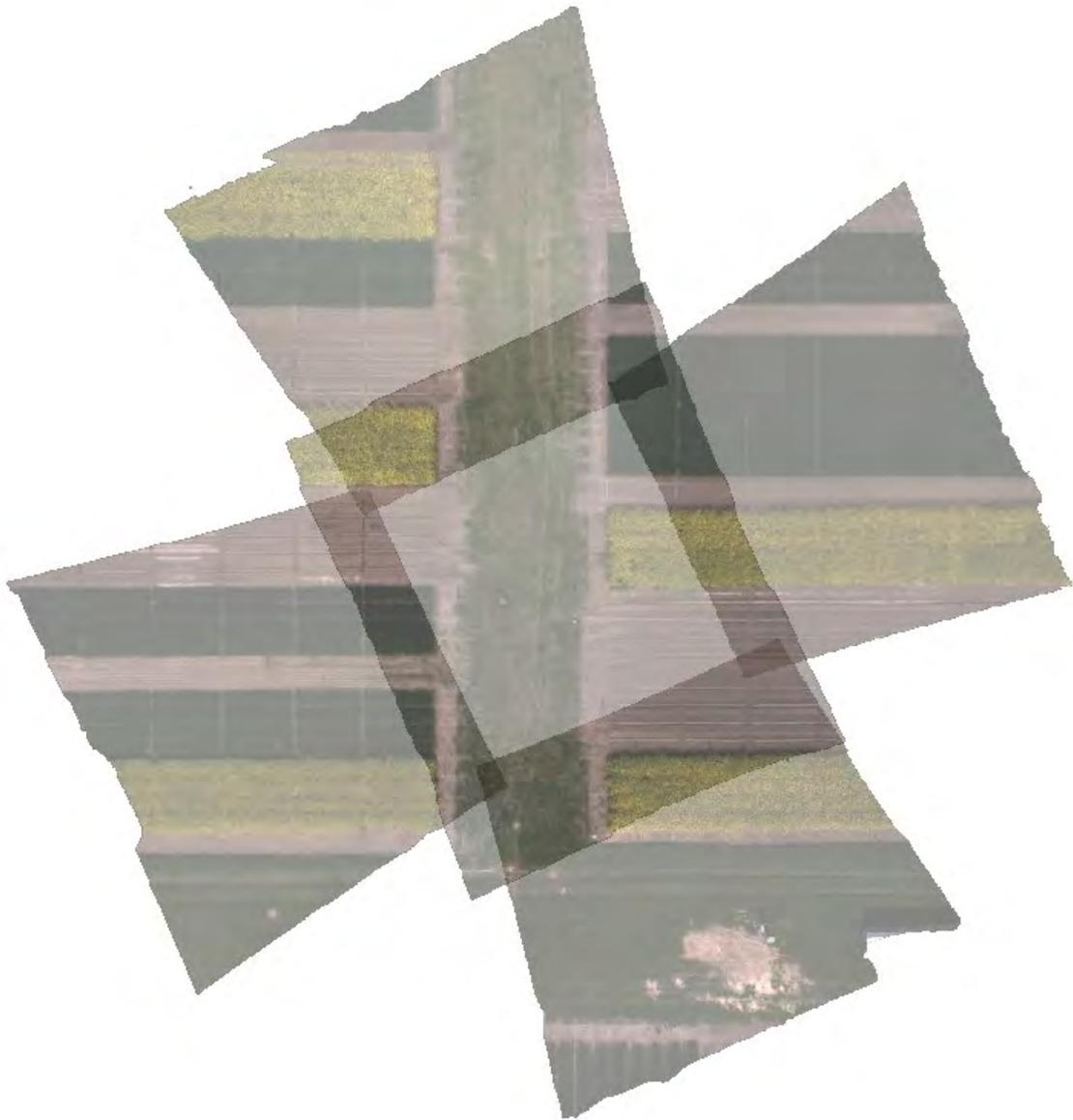
**Abbildung 101: Aufnahmeset des „Four Vision“-Kamerasystems mit 50%iger Transparenz**
