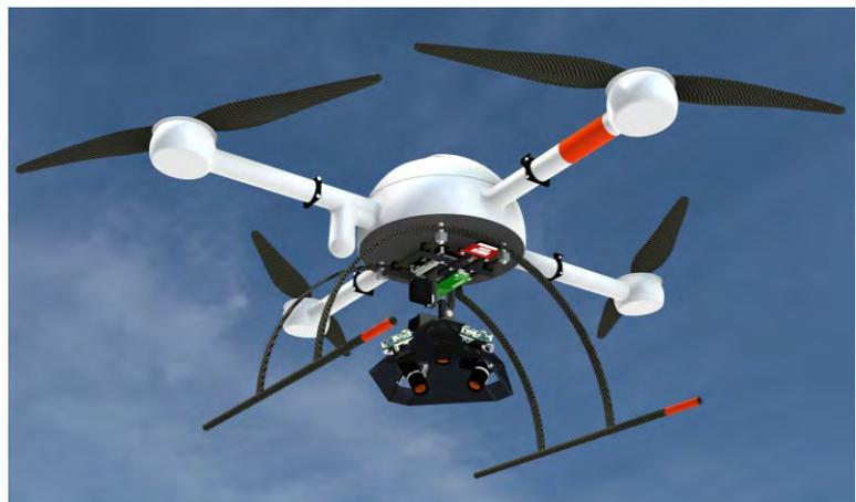
**Abbildung 62: Entwurf "Four Vision"-Kamerasystem unter MD4-1000**
