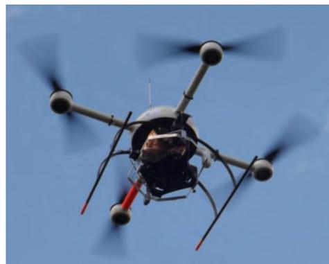
Abbildung 96: MD4-1000 mit „Four Vision“-Kamerasystem während des Fluges
